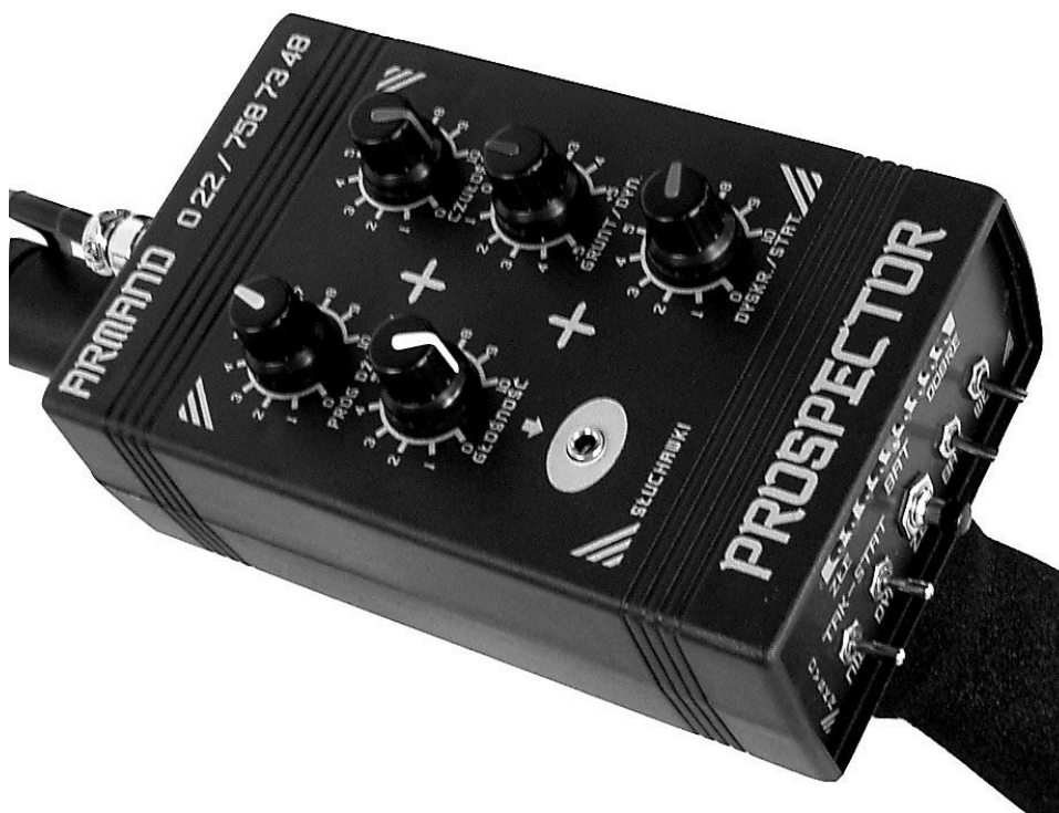
Ryc. 15 Widok elementów manipulacyjnych wykrywacza posiadającego rozbudowane funkcje [fot. W. Oksieñciuk].
